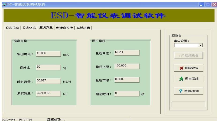
4. 制造商校正 通过此页面可以对流量计进行整机总装调试。
