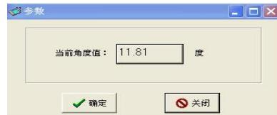
等显示值稳定 1-2 秒，点确定按钮，进入下一点校正。将指针定位到下一个校正点，重复以上操作。直至完成所有校正点。点击下载校正数据按钮，将出现以下提示框：
