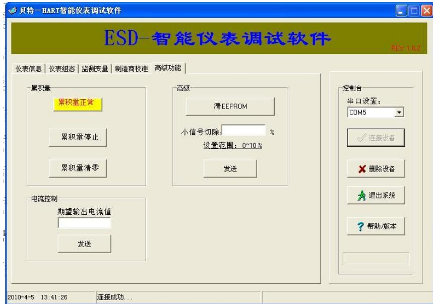
通过此页面可以停止/启动累计，设置小信号切除量，清除累积量。电流控制功能是用来系统调试用的，可以在输入框中输入一个 4-20mA 的电流值，点击发送，使输出电流固定在某一电流值。在输入框中输入 0，可恢复到正常工作状态。设置小信号切除量时，在输入框中输入切除量范围后，点击发送按钮，将数据下载到下位机。
