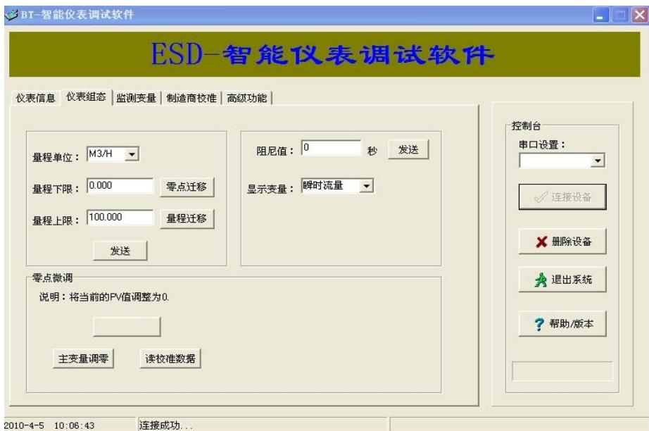
通过此页面可以修改：流量量程、流量单位、阻尼时间，修改主变量显示项目，进行零点微调。
