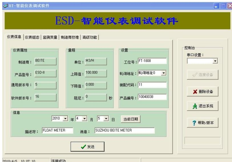
在此界面中，可以修改：工位号、装配代码、出厂编号、当前日期、描述符和消息。修改后点击发送键。就能保存在下位机中。
