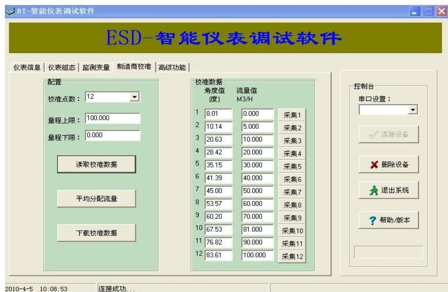
线性校正点范围：2-12 点，量程上限输入框中输入满量程流量。量程下限默认值为 0。
